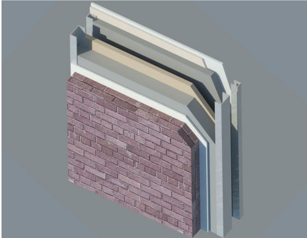
Figura 1.3-1: Stratigrafia 3D eseguita con il software Autodesk Revit, di un pacchetto a secco tipo, con i relativi montanti. Si tratta del pacchetto a secco utilizzato nel corso della tesi (soluzione ibrida con presente anche la facciata in laterizio).
